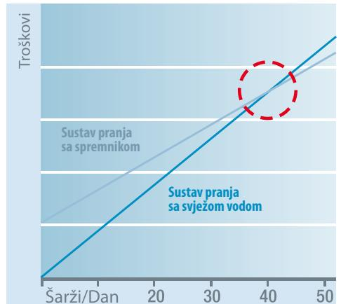
Dijagram prikazuje visoku ekonomičnost sustava za pranje svježom vodom nasuprot pranja u sustavu sa spremnikom
